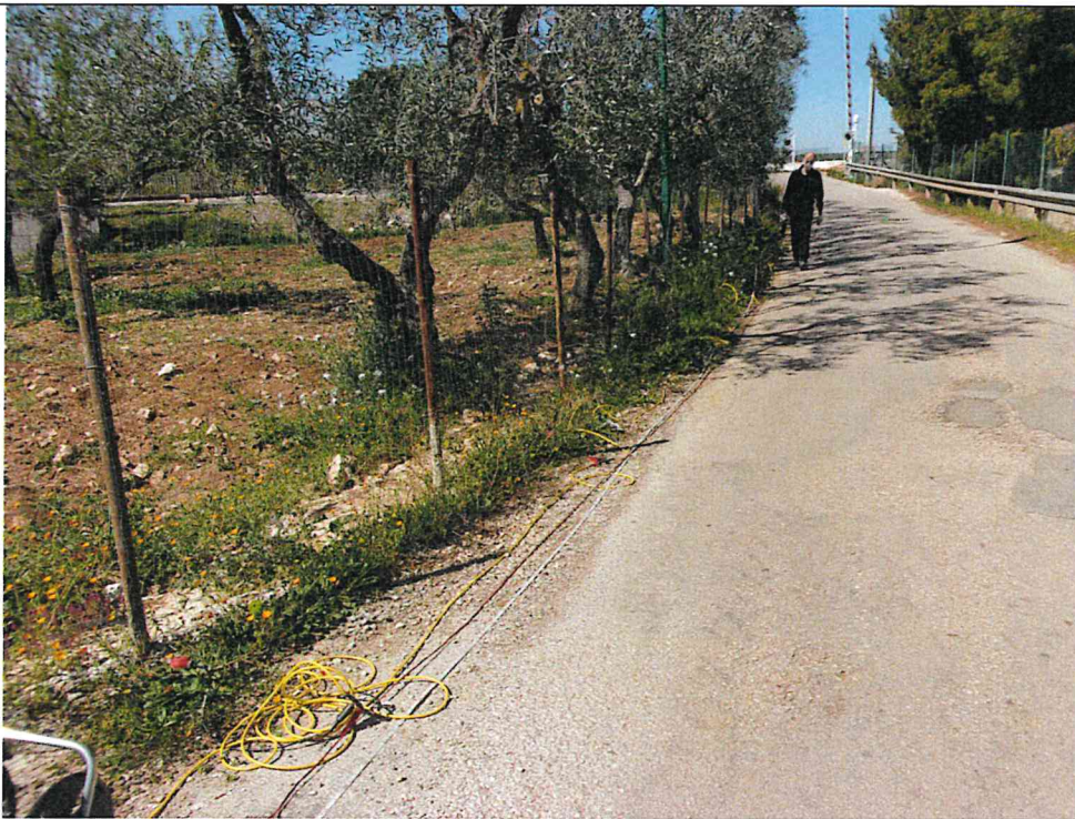
Esecuzione profilo sismico a rifrazione M8_2 e Masw sullo stesso stendimento
